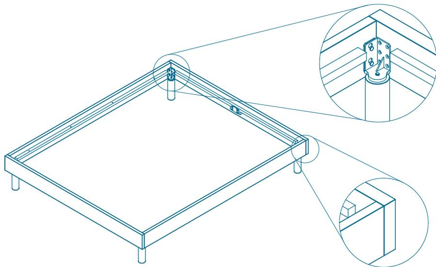
8. センターレールに中脚を時計回りに回転させながら取り付ける。
